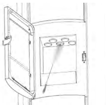
Fig. 24 - Reinigung der Rohrbündel
