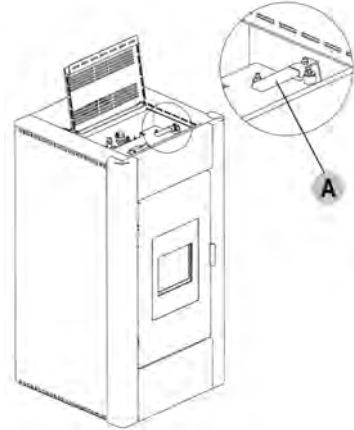
Fig. 23 - Hebel für die Reinigung der Rohrleitungen (Idro Prince 30-30 H20)
